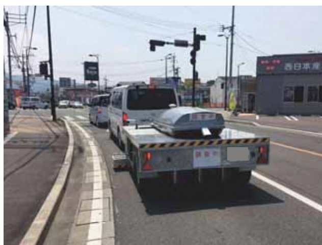
路面下空洞探査車
