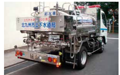
ポンプ付き給水車
