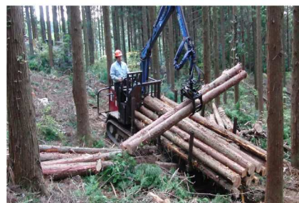
フォワーダによる木材の搬出状況
