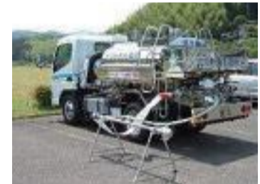
給水車、仮設給水栓
